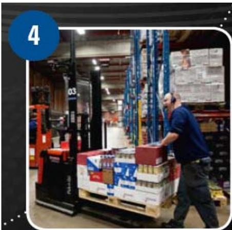
Se envía una nueva línea del pedido. La carretilla se desplaza automáticamente hasta la siguiente posición
