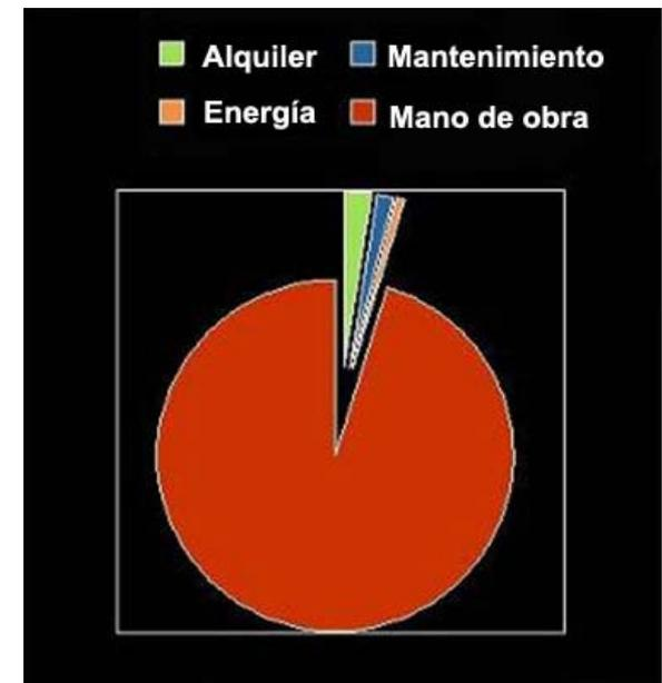
*Costes de mantenimiento de una flota de carretillas*
